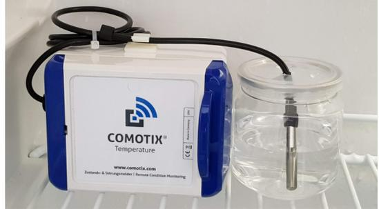
Die Positionierung des Sensors in etwas Flüssigkeit kann auch sinnvoll sein, wenn Ihr Kühlschrank über eine sogenannte dynamische Kühlung (per Umluft) verfügt.
