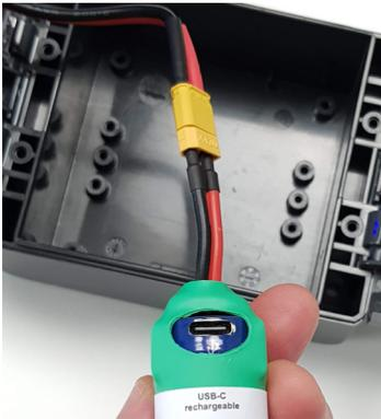
Der COMOTIX® wird inklusive Spezial-Akku ausgeliefert. Der Akku ist bei Auslieferung vorgeladen. Eine komplette Ladung vor der ersten Inbetriebnahme ist aber zu empfehlen.
