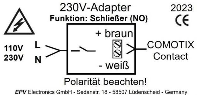
Der 230V-Adapter ermöglicht den Anschluss **von 230V-Alarmausgängen, z.B. an Heizungen, an einen COMOTIX Contact Melder.**
