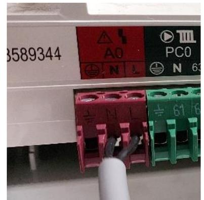
Das **bereits vorhandene** Kabel am 230V-Adapter wird an den 230V Störausgang angeschlossen. Das Kabel des COMOTIX Contact Melders wird an die Klemme im Schaltadapter angeschlossen.
