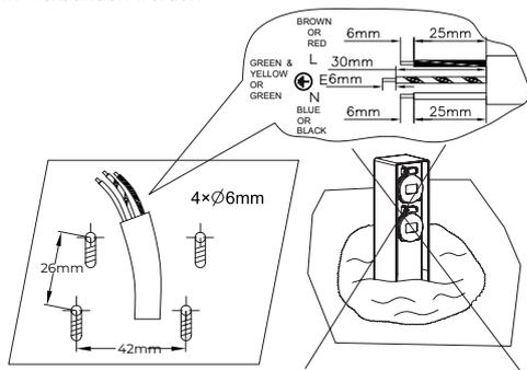
3. Entfernen Sie die Kabelhalterung von den Steckdosen mit einem Schraubendreher, führen Sie das Kabel durch die Öffnung am unteren Ende der Steckdose, und verbinden Sie die "L", "N" und "E" Anschlüsse entsprechend mit dem Schraubendreher. Bringen Sie die Kabelhalterung wieder an den Steckdosen an und stellen Sie sicher, dass das Kabel fest sitzt.
