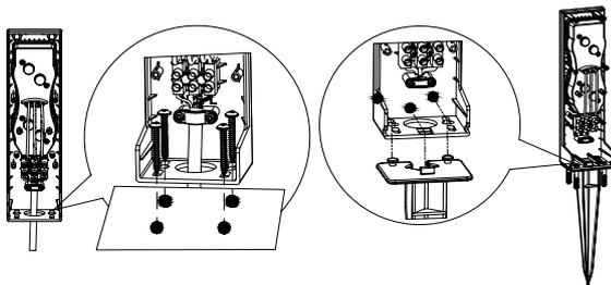
5. Setzen Sie die Abdeckplatte in die Steckdose ein und führen Sie das Erdungskabel durch die Klemmnut der Abdeckplatte. Drücken Sie das Kabel nicht zusammen und befestigen Sie es mit zwei Schrauben. Setzen Sie die Steckdose in die Abdeckung ein und sichern Sie das Produkt mit sechs Schrauben.
