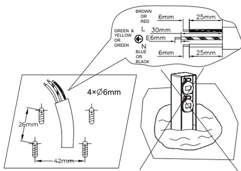
3. Verwijder de kabelklem van de contactdozen met een schroevendraaier, voer de kabel door de opening aan de onderkant van de contactdoos, draai de schroeven aan en verbind de "L", "N" en "E" aansluitingen met een schroevendraaier. Plaats de kabelklem weer op de contactdozen en zorg ervoor dat de kabel stevig vastzit.
