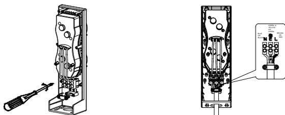
4. Installieren und befestigen Sie die Steckdose mit einem Schraubendreher in den vier vorbereiteten Löchern.
