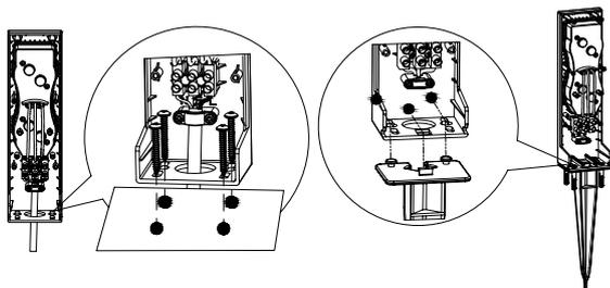
5. Insérez la plaque de recouvrement dans la prise et faites passer le fil de terre dans la rainure de la plaque de recouvrement. Ne serrez pas le fil et fixez-le avec deux vis. Insérez la prise dans le couvercle et fixez l'ensemble avec six vis.
