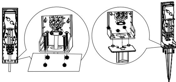
5. Plaats de afdekplaat op de contactdoos en voer de aardingskabel door de klemgroef van de afdekplaat. Druk de kabel niet samen en bevestig deze met twee schroeven. Plaats de contactdoos in de afdekplaat en bevestig het geheel met zes schroeven.
