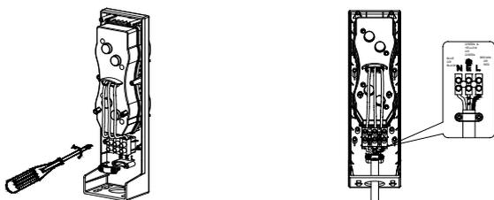
4. Installeer en bevestig de contactdoos in de vier voorbereide gaten met een schroevendraaier.
