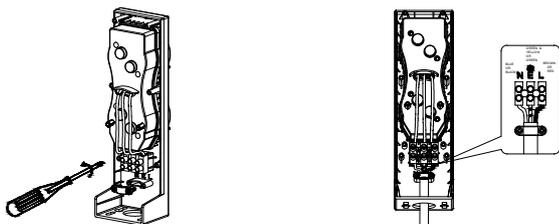
4. Installez et fixez la prise dans les quatre trous préparés à l'aide d'un tournevis.
