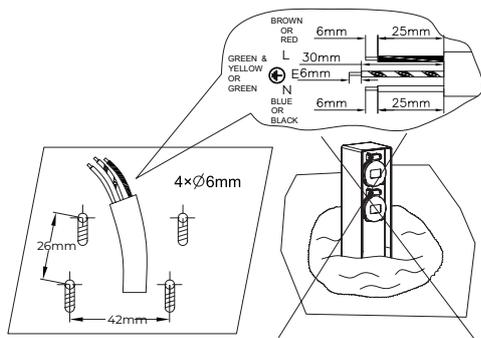
3. Retirez l'ancrage de câble des prises avec un tournevis, passez le fil par le trou situé au bas de la prise, serrez et connectez les bornes "L", "N" et "E" correspondantes avec un tournevis. Remplacez l'ancrage de câble sur les prises et assurez-vous que le fil est bien fixé.
