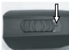
Fig. 4 Kontakt i OFF-position ("0")
