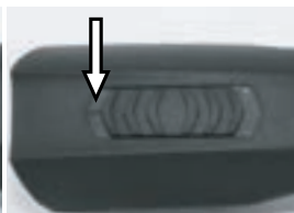
Kuva 5 Kytin ON-asennossa ("I")
