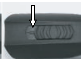
Fig. 6 Bryter i PA-posisjon ("II")
