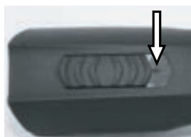
Fig. 4 Brytare i läge FRÅN ("0")
