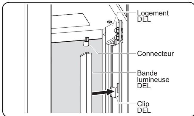
Remplacer une bande lumineuse DEL
