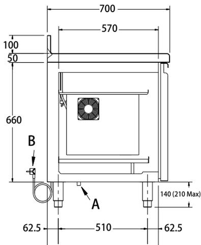
A: Drain pipe Tuyau d'écoulement Abflussrohr
