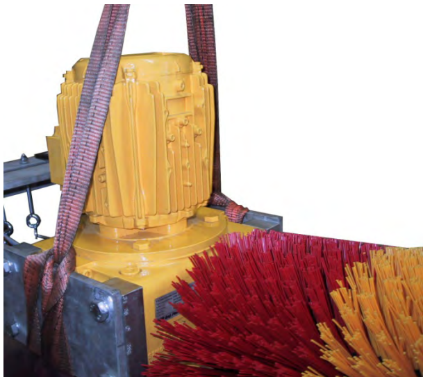
Illustration 3: fixation de la sangle de levage
