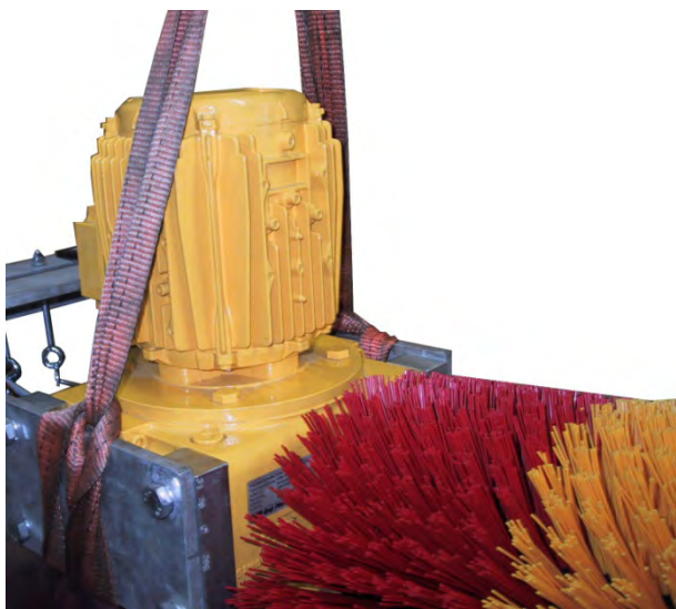
Abbildung 3: Befestigung des Hebegurtes
