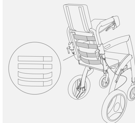
Figuur 54: Voor en na het afstellen van de verstelbanden, aan de rechterkant zie je de correcte zitpositie.
