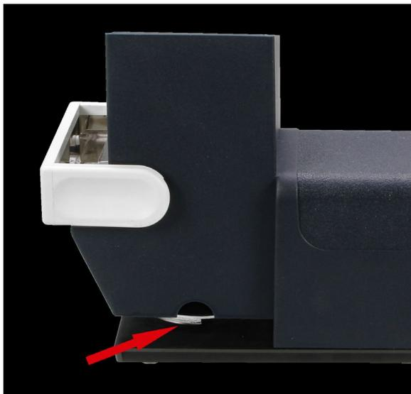
Le Signoscope est réglé en usine pour une épaisseur de timbre normale. Dans des cas exceptionnels, le levier de position doit être réajusté pour des timbres très fins ou très épais.
