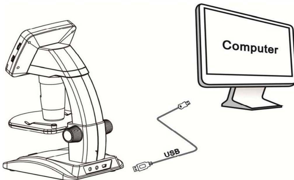
Connectez le microscope à l'ordinateur à l'aide du câble USB fourni. Sélectionnez ensuite le mode Caméra PC. Lancez le logiciel PortableCapture à utiliser avec le microscope. Lorsque vous connectez le microscope à l'ordinateur, les boutons de l'écran sont désactivés. Le logiciel est décrit plus loin dans ce manuel.
