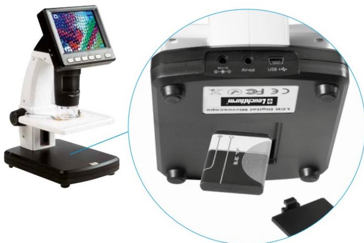
L'état de charge de la batterie est indiqué en bas à droite de l'écran. D'autres indicateurs sont l'éclairage LED et la qualité de l'image.
