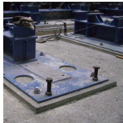
PCI Repaflow Uni zorgt voor een naadloze, scheur- en holtevrije verbinding, dus een rustige basis voor machines, nauwkeurig werken en minder slijtage
