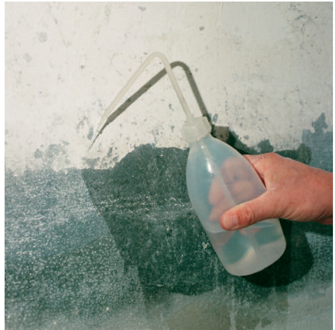
De olie kon voldoende van de wand verwijderd worden. Hier een demonstratie van het sproeien van water dat enigszins indringt en daarna wegparelt.
