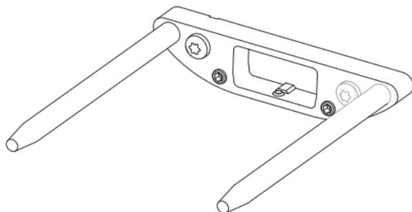
Mounting kit leicht lösen und mit Inbusschrauben ausrichten.
