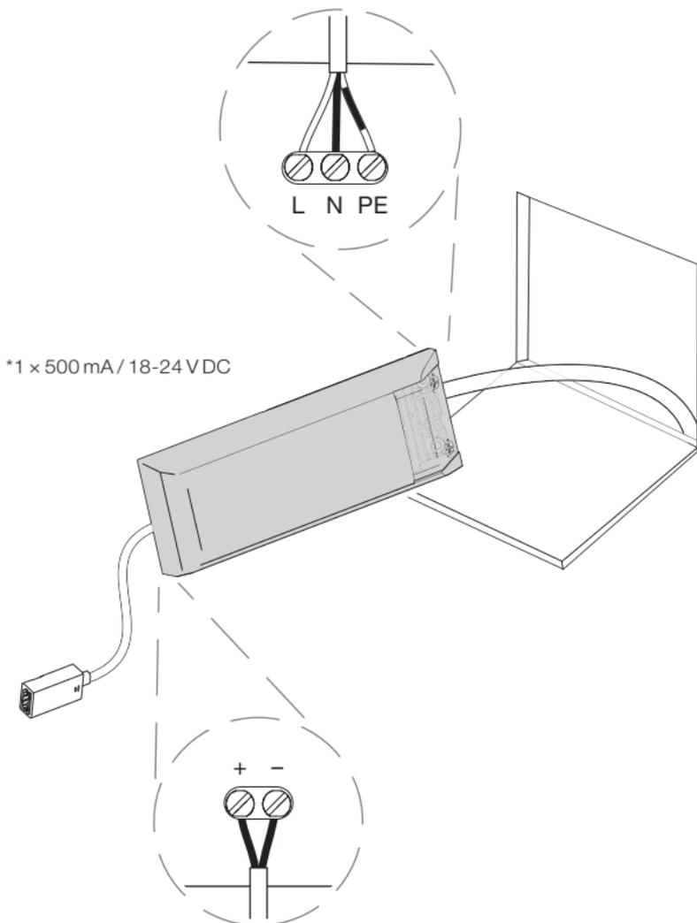
Vorschaltgerät in der Wand verstauen und das Kabel durch die Bohrung führen.
