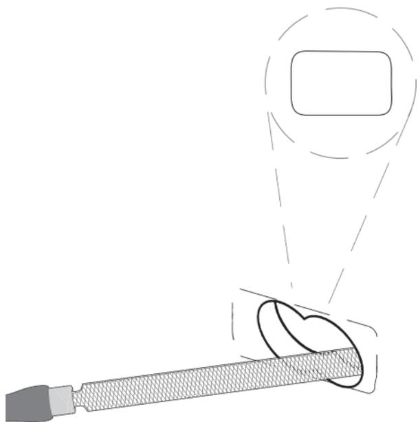
Äußere Kabelisolation wandbündig abisolieren, Einzeladern wie abgebildet zur Verkabelung vorbereiten.
