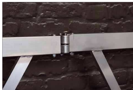
In der Mitte der Verbindungsstrebe befindet sich ein Gelenk, das durch einen Sicherungsstift arretiert wird
