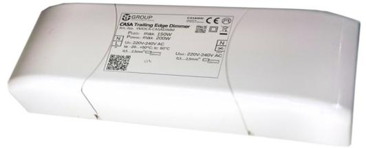
Der CASA Trailing Edge Dimmer ist ein Phasenabschnittsdimmer. Sein Einsatz ermöglicht stufenloses Dimmen von Phasenabschnittsleuchtmitteln. Ausgangsleistung 150W LED / 200W ohmisch (z.B Glühlampen). Gesteuert wird er drahtlos mit der CASAMBI® App. Zugenlastung und Klemmenabdeckung sind integriert.
