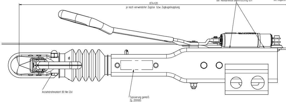
Der Kopf der Schraube, mit welcher die Aufreifeneichung auf der Zugdeichsel montiert wird, muß auf dieser Seite Liegen, da sonst die Freigängigkeit der Handbremse beeinträchtigt ist!
