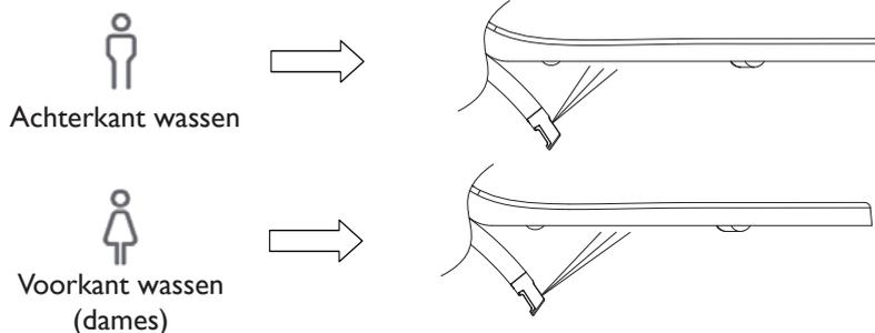
Als u het wasprogramma gebruikt zal dit eerst 10 seconden op de vaste positie staan. Hierna volgt een beweegbare wasbeurt gedurende 18 seconden en gaat de douche-arm terug naar zijn vaste positie.
