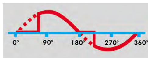
Phasenanschnittsteuerung für Glüh- und Hochvolt-Halogenlampen oder NV-Halogenlampen mit gewickeltem Trafo
