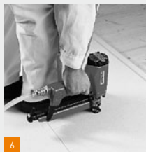
6 ... of nieten met speciale spreidnieten
