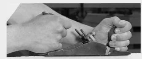
Plaatkant schaven met surformschaaf
