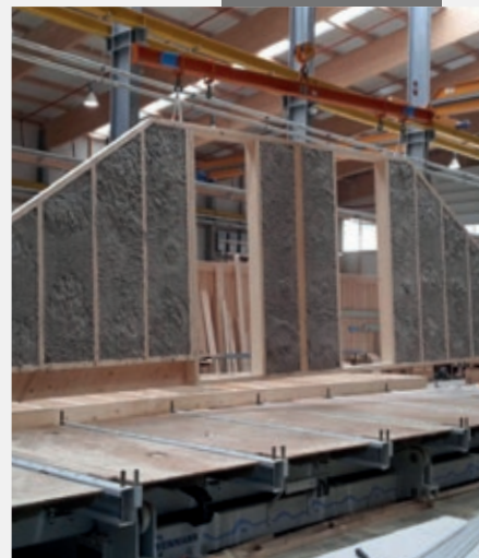
De vezels verstrengelen zich in het bouwelement tot een isolatiemat op maat.
