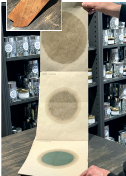
Peignez des surfaces absorbantes ! Un test simple pour vérifiez la pénétration et les propriétés protectrices de la peinture ou de l'huile.
