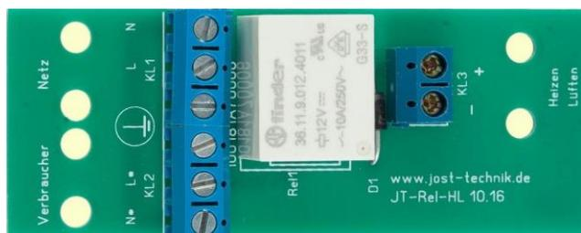
Figure 2 : Module de raccordement Rel-HL
