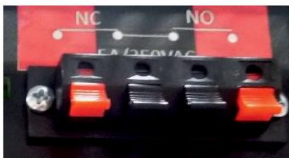
Branchement alarme à distance
