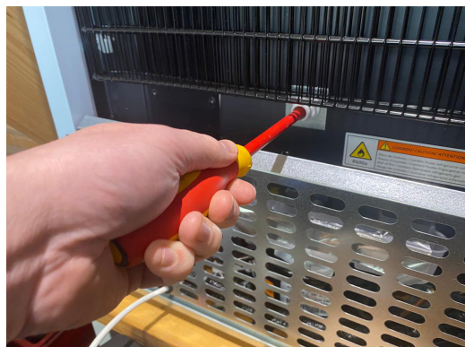
2. Duw met een schroevendraaier de stop aan de binnenkant eruit.
