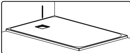
Markeer de positie van de afvoer en bepaal de plaats van de afvoer en de douchebak
