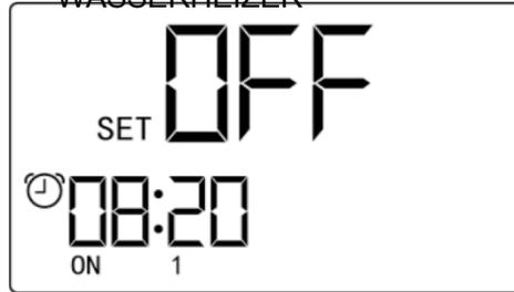
Abb.4.4-3 Einstellung der ON/OFF-Zeit des Timers
