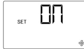
.4.5-6 Lüftungsfunktion ist eingeschaltet
