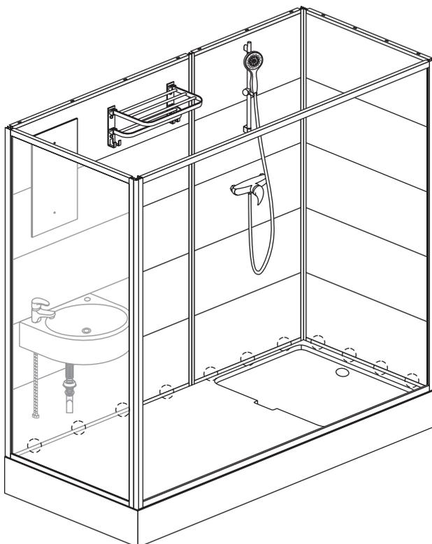
Bohren Sie die Löcher vor und bringen Sie Silikon in die Löcher und auf die Schrauben auf.
