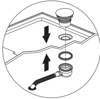
Heben Sie den hinteren Teil der Bodenplatte hoch und stecken Sie ein Ende des Rohrs in die Abflussöffnung.
