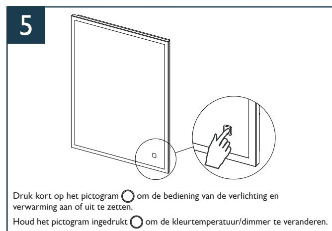
Druk kort op het pictogram om de bediening van de verlichting en verwarming aan of uit te zetten.
