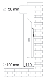
Slika 10: Razmaci grijalice nakon montaže
