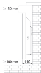
Slika 11: Odmiki grelnika po montaži
