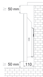
Bild 13. Abmessungen der Standheizkörper in montierter Stellung
