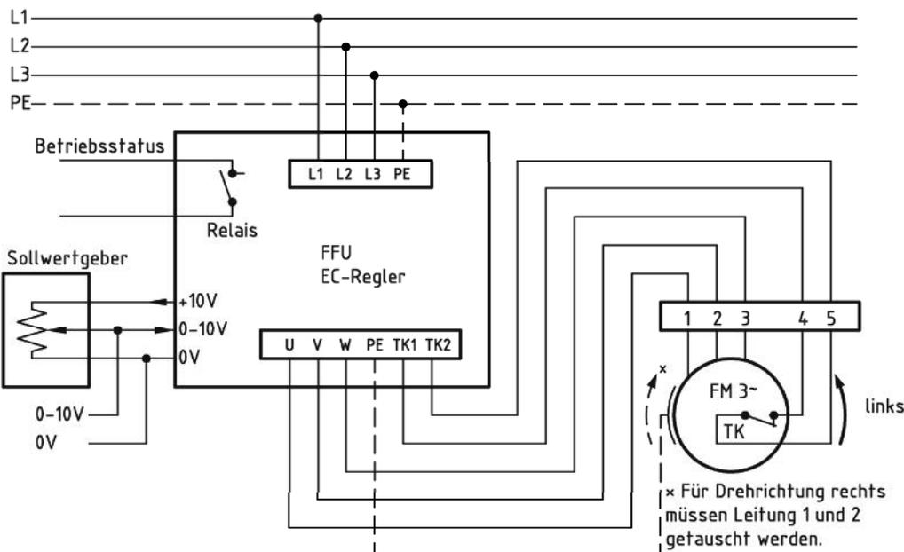
\* Das Anschließen der Geräte erfolgt nur nach den beigegeführten Technischen Unterlagen
