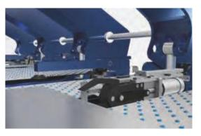
Die einzigartige Öffnungshöhe von 700mm ermöglicht das manuelle Wenden mit nur einer Person direkt am Maschinentisch. Zudem erlaubt dieses Design das Einlegen und Abrollen von Kleincoils direkt in der Maschine.
