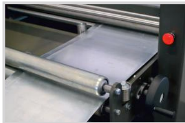
Verstelbare zijgeleiding met handwiel voor smallere coils
