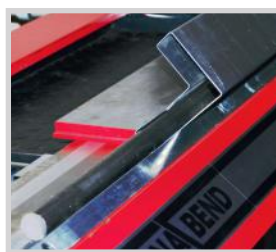
Unieke buigingen mogelijk door magnetische klemming
