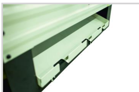
Vaste terugvoerplaat waardoor korte plaatjes naar voren vallen
