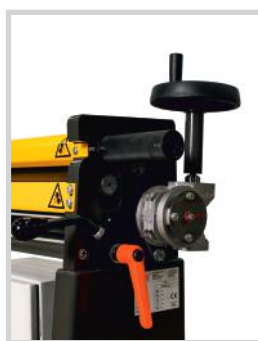
Uitzwenkbare bovenrol voor het uittrekken van gewalste buizen
