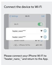
Después de hacer clic en el signo más de la esquina superior derecha, sigue las instrucciones para entrar en la configuración de Wi-Fi móvil y selecciona la Wi-Fi llamada heater\_nano\_xxxx para conectarte. Este proceso no requiere introducir una contraseña.
