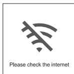
Когда на экране появляется этот символ, необходимо проверить, правильно ли отображается IP-адрес на экране. Если он нормальный, то текущий сбой Wi-Fi исключен, и проверьте настройки, такие как оператор связи, пула для майнинга или VPN. Если IP-адрес отображается как 0.0.0.0, это означает, что настройка сети не удалась, проверьте, работает ли ваш Wi-Fi правильно, и не введен ли неправильный пароль.
