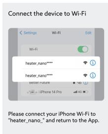
После нажатия на знак плюс в правом верхнем углу, следуя подсказкам, перейдите на страницу настройки Wi-Fi вашего мобильного телефона и выберите Wi-Fi с именем heater\_napo\_xxxx для подключения к нему, пароль при этом вводить не нужно.
