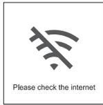
この記号が画面に表示されたら、画面に表示されるIPアドレスが正しく表示されているかどうかを確認する必要があります。正常であれば、現在のWi-Fi障害をトラブルシューティングし、通信事業者、マイニングプールの設定、またはVPNなどの設定を確認します。IPが0.0.0.0と表示されている場合は、ネットワークの設定に失敗しています。Wi-Fiが異常でないか、パスワードが間違っていないか確認してください。
