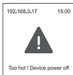
Если на экране появляется символ, это означает, что внутренняя температура устройства слишком высока. Пожалуйста, проверьте, чисты ли отверстия для выхода и входа воздуха в устройство, и очистите их.
