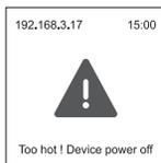
Wenn das Symbol auf dem Bildschirm erscheint, bedeutet dies, dass die Innentemperatur des Geräts zu hoch ist. Prüfen Sie, ob der Luftauslass und der Lufteinlass des Geräts frei sind, und reinigen Sie sie.
