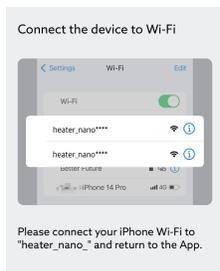
點擊右上角加號之後，根據提示自行進入手機Wi-Fi設置，並選擇名稱為heater\_nano\_xxxx 的Wi-Fi進行連接，該過程不需要輸入密碼。連接成功後切回Avalon Remote App並點擊Next step。
