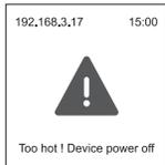
画面にこの記号が表示される場合は、機内温度が高すぎることを示しています。機器の排気口と吸気口が空いていることを確認し、掃除してください。アイコンが繰り返し表示されて再起動する場合は、電源を切って販売後に連絡してください。
