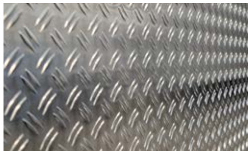
Bodemplaat met geribbelde aluminium plaat
