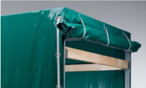
Huif en dakbogen, laadhoogte 1600 mm/1800 mm/2000 mm
