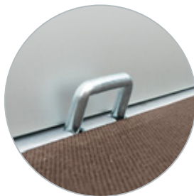
8 bindhaken aan binnenzijde laadbak
