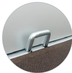
8 Bindhaken aan binnenzijde laadbak
