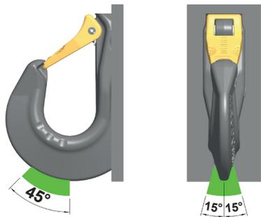
Abb. 1: Zulässige Belastungsrichtungen
