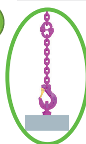
Abbildung 1: Richtige Montage und Anwendung
