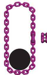
Abb. 1: Kette nicht verdreht und Verwendung im freien Kettenstrang
