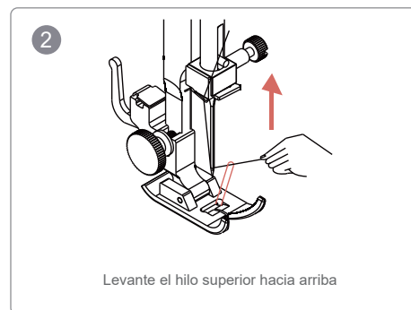
Tire suavemente del hilo superior y presione el botón de posición de la aguja dos veces al mismo tiempo
