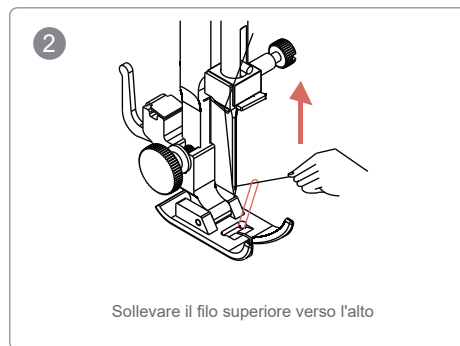
Tirare delicatamente verso l'alto il filo superiore e premere contemporaneamente due volte il pulsante di posizione dell'ago
