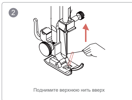
Осторожно потяните верхнюю нить и одновременно дважды нажмите кнопку позиционирования иглы
