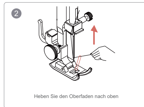
Ziehen Sie den Oberfaden vorsichtig hoch und drücken Sie gleichzeitig zweimal die Nadelpositionstaste.
