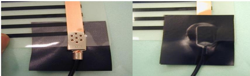
**Nach der Installation HINWEIS:** Isolieren Sie immer die Crimpverbinder. Schneiden Sie 2 Stück Isolierband ab und kleben Sie sie auf beiden Seiten über die Crimpverbinder. Das Isolierband muss mindestens 5 mm über dem Ende des Crimpverbinders angebracht werden. Außerdem muss das Ende der Fußbodenheizungsfolie mit Isolierband isoliert werden.
