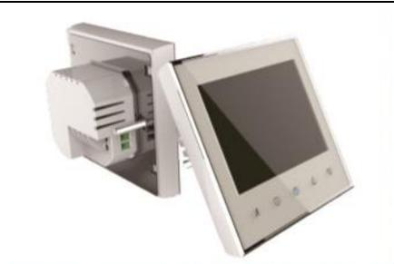
De aansluiting dient door een erkend installateur te worden uitgevoerd overeenkomstig de NEN 1010 voorschriften. Voor montage of demontage van de thermostaat altijd de elektriciteit in de meterkast uitschakelen. De thermostaten van Quality Heating zijn te monteren in een enkelvoudige inbouwdoos van 5CM diep, volgens standaard DIN formaten. Controleer altijd of de stroom is afgesloten.
