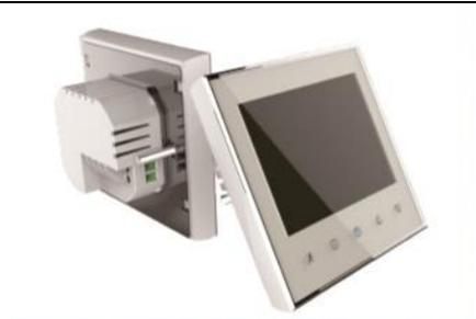
Der Anschluss muss von einem anerkannten Elektriker gemäß NEN 1010 durchgeführt werden. Schalten Sie immer den Strom im Zählerschrank aus, bevor Sie den Thermostat installieren oder entfernen. Die Thermostate von Quality Heating können in einer einzigen Unterputzdose mit einer Tiefe von 5 cm gemäß den Standard-DIN-Formaten montiert werden. Überprüfen Sie immer, ob die Stromversorgung ausgeschaltet wurde.
