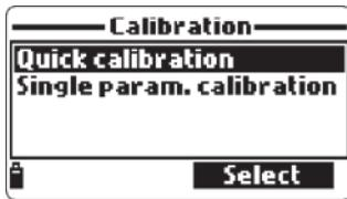
Zur Auswahl der Option drücken Sie **Select**. Die Option ermöglicht die Ein-Punkt-Kalibrierung für die Messgrößen pH-Wert, Leitfähigkeit und gelöster Sauerstoff in einem Kalibrierschritt. Diese Art der Kalibrierung ist speziell für den Outdooreinsatz geeignet.
