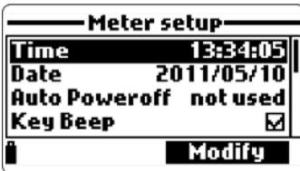
Die Option ermöglicht die Einstellung der eingebauten Echtzeituhr.
