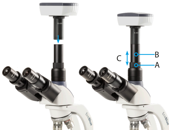
Trinoculaire EcoBlue-kop met camera in fotopoort gemonteerd
