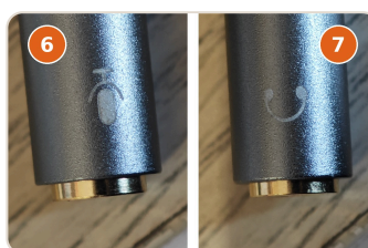
Abbildung F • Jeder Ausgang des Splitters trägt sein eingraviertes Symbol: ein Mikrofon und ein Kopfhörer
