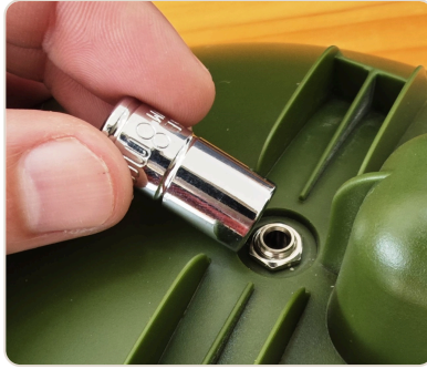
Abbildung E · Der 8-mm-Schlüssel am Gewinde des Spiegels
