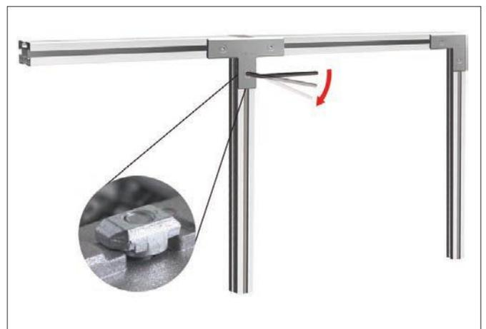
Die SSP FAST CONNECT Technologie ermöglicht eine einfache und schnelle Verbindung der einzelnen Aluminiumprofile. Bohren und Gewindeschneiden ist durch diese neuartige Technik nicht mehr notwendig. Dies spart Zeit und Geld in der Montage.
