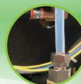
Inwendige stoomslangen speciaal EPDM met teflon uitgevoerd
